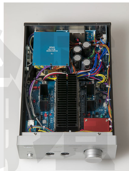
● 搭配使用的擴大機SRM-700S，採用全晶體方式驅動，前端先以Dual FET架構取得出色的訊噪比，末端再以PB002輸出模組，以一對2SC6127電晶體做驅動，而關鍵的音量控制，則透過紅色的金屬外殼做屏蔽處理。
