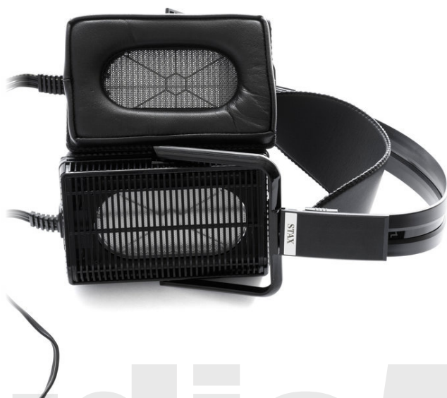
SR-L700耳罩是較傳統的長方形。採用與SR-009相同技術的MLER導電板，目前只有這兩者使用。耳罩材質則是羊皮。
