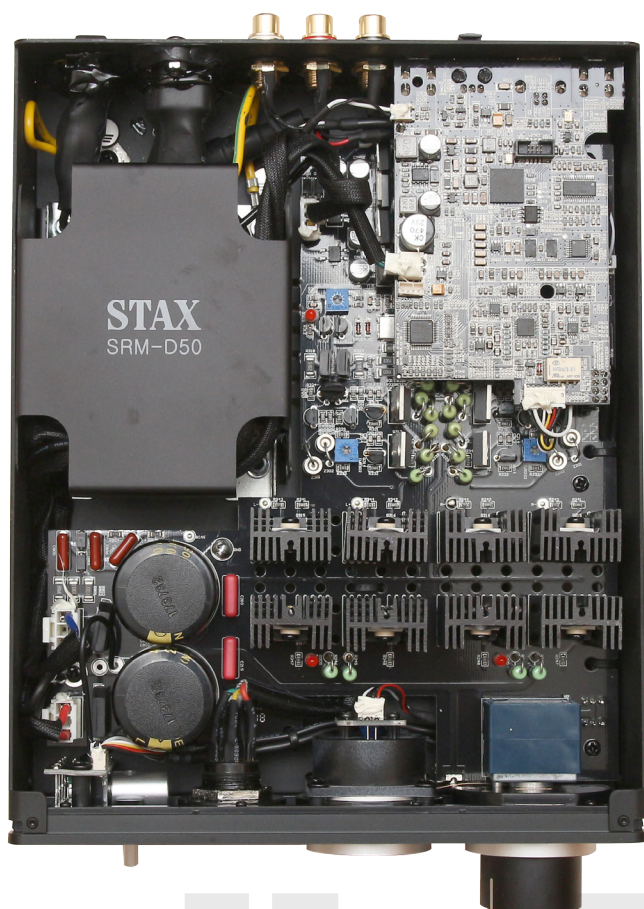
SRM-D50內部幾乎四分之一都被R形變壓器給佔去。另外四分之一則是電源濾波，顯示對於電源供應所下的功夫。至於數位訊號處理與功率晶體則各佔四分之一的空間。
