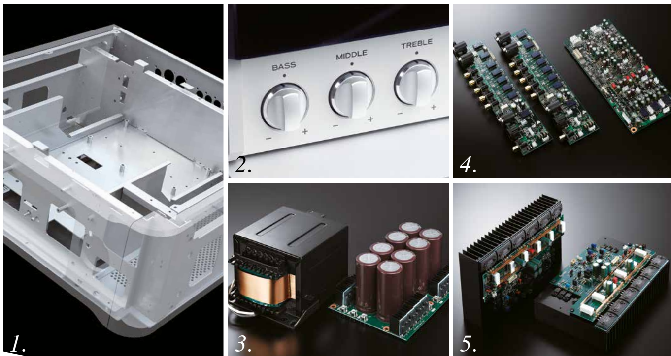
▲圖1. 機箱的結構，關乎音質的安定與精純，Esoteric常用的雙層機箱構造，在此機上發揮得淋漓盡致，兼有強化與隔離功能，在綜擴中少見。圖2. 很高級的音調控制，將中音衰减即可得響度控制效果，聆聽古董喇叭或老黑膠時，可用來調整音色。圖3. 電源組件的特寫，940VA的容量足可供600W以上的功放使用，相對於本機的輸出，可謂奢華至極。圖4. 從輸入端至輸出端，皆為Dual-Mono設計，兩聲道電路連佈局都完全相同，以獲得一致的阻抗特性，讓兩聲道的表現完全一樣。圖5. 功放單元特寫，每邊六枚大電流功率晶體，足以承載300W功率，本機安全係數之高令人乍舌。
