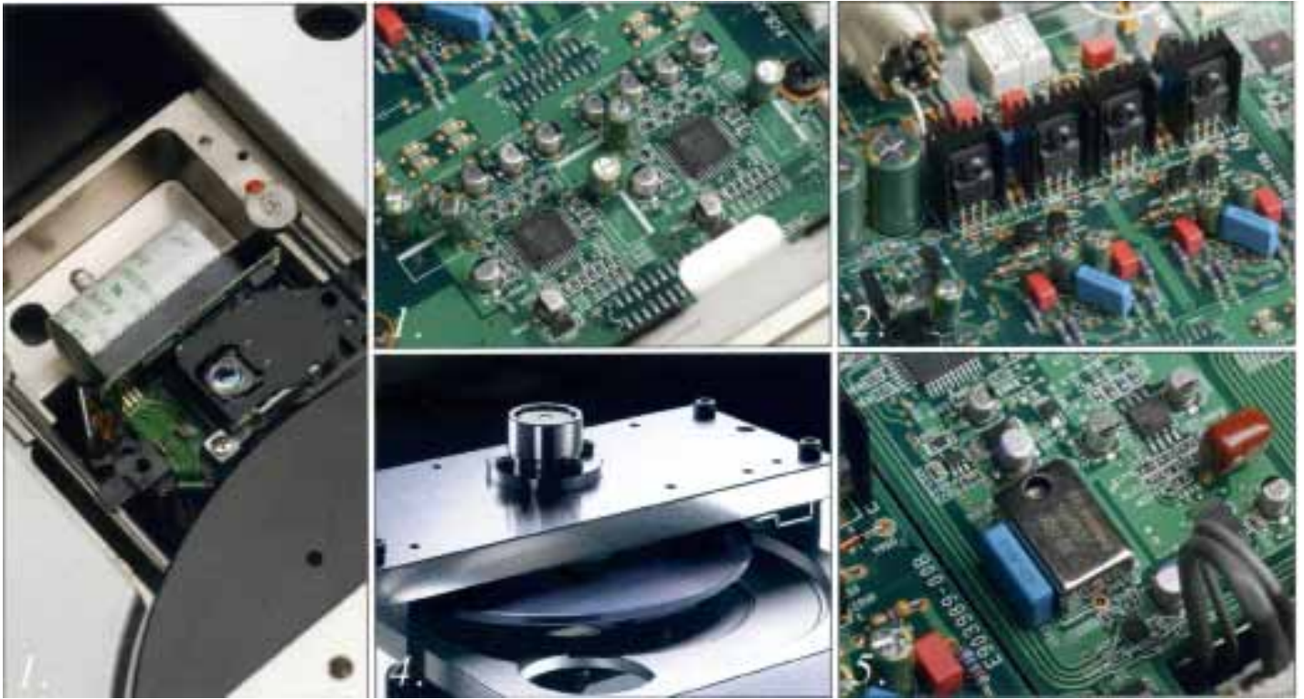
▲圖1. K-03的讀取裝置依然是廠方引以為傲的「軸擺動式」雷射讀取頭，讓雷射光束能保持與碟片垂直的狀態。圖2·本機每聲道採用了兩組32Bit的AKM4399晶片以並聯/差動方式工作。圖3·本機的類比輸出電路是採取各別元件以Discrete方式製作，而非選用現成的OP晶片。圖4·K-03當然採用了Esoteric招牌大作:重量級VRDS-NEO傳動機構，組件重達4.4公斤。圖5·採用精度高達正負0.5ppm的VCXO(壓控)震盪晶體，而不需PLL電路，做為精密時脈參考頻率的來源。
