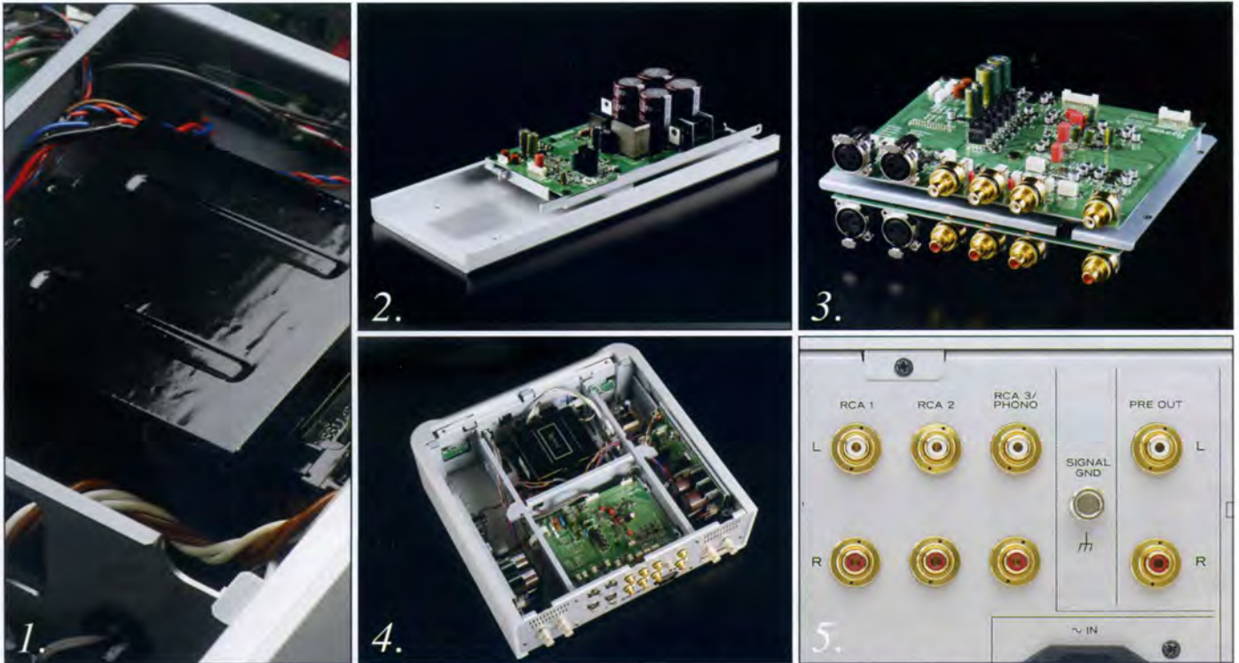
▲圖1. 電源供應採用重達10公斤的傳統變壓器。圖2. 符合MSW信念的D類功率模組。圖3. 兩聲道完全隔離的前級電路。圖4. 兼具隔離效果的內部補強結構。圖5. 內藏MM/MC放大器，也可當作前級使用。
