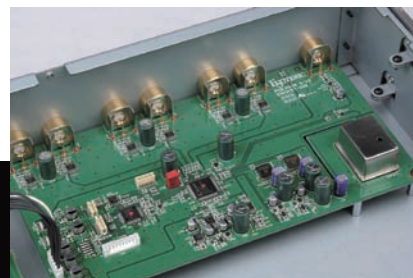
▲最右方的金屬盒就是G-03X採用的高精密OCXO振盪器。
