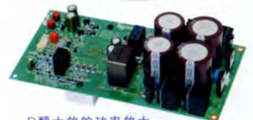
D類大放的功率放大器電路板，這塊電路板是透過鋁板被安裝在左右的側面板上，開關元件的MOS-FET(參考下方的照片)被收納在電路板背面偏左一些的白色盒子內。
