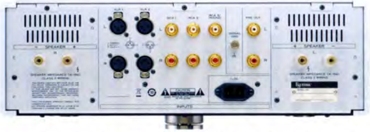
合併放大器I03有2組平衡輸入、3組非平衡輸入、以及1組前置輸出的類比與線路輸出端子，其中1組非平衡輸出(RCA)能夠切換成內建的MM唱頭、又或是MC唱頭其中一種輸入，只想使用前置放大器，還能有效停止功率放大器驅動的Power Amplifier Shutdown功能。
