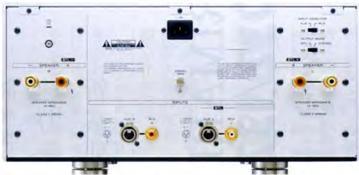
A02背面，右上方設置平衡 / 非平衡輸入切換開關，以及STEREO模式 / BTL模式切換開關，揚聲器輸出端子採用WBT公司製Nextgen WBT0710Cu。
