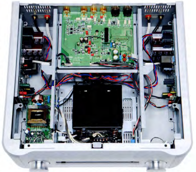
I03內部，合計被分割成五塊電路板，包括中央前方的類比電源部(並非交換式電源)、左右聲道的電路板被分割成上下兩塊的中央後方的前置放大器、還有左右獨立化的D類功率放大器，功率放大器的開關元件等所散發出來的熱氣是經由側面板散出的設計形式。
