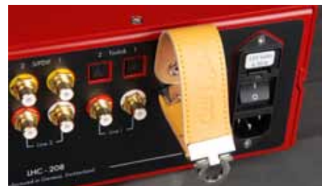
左圖 面板上只看到一個頗大的顯示窗，竟沒有旋鈕或按鈕。原來顯示窗是觸控面板，除了透過遙控器之外，必須透過按壓顯示窗來操控。 中圖 這三個紅色圓片都「不是」按鈕，由左至右分別是耳機輸出、紅外線接收孔與3.5mm輸入，跟一般器材大不相同。 右圖 本機背後還有一個Type A的USB，它不是用來連接電腦，而是用來插入「鑰匙」。如果沒有插入原廠附的這根隨身碟，機器無法啟動喔！
