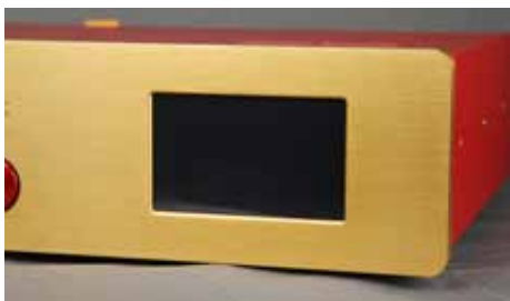
左圖 面板上只看到一個頗大的顯示窗，竟沒有旋鈕或按鈕。原來顯示窗是觸控面板，除了透過遙控器之外，必須透過按壓顯示窗來操控。 中圖 這三個紅色圓片都「不是」按鈕，由左至右分別是耳機輸出、紅外線接收孔與3.5mm輸入，跟一般器材大不相同。 右圖 本機背後還有一個Type A的USB，它不是用來連接電腦，而是用來插入「鑰匙」。如果沒有插入原廠附的這根隨身碟，機器無法啟動喔！
